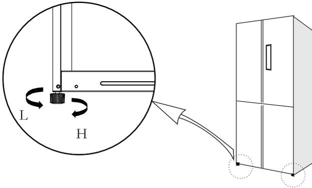
Если холодильник установлен не по уровню, дверь и магнитные уплотнители будут закрываться неплотно.
