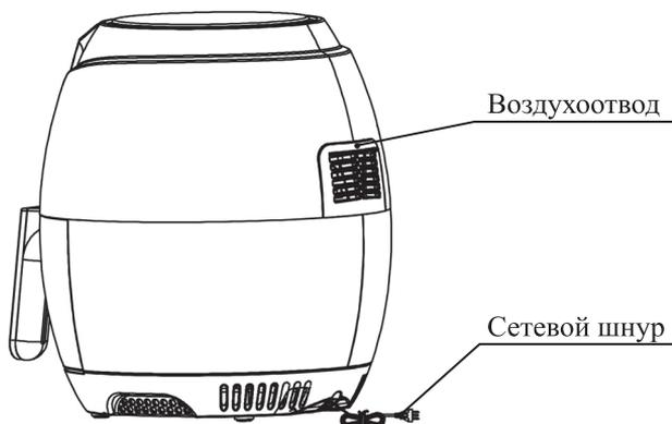
Принцип работы аэрогриля основан на конвекции воздушных потоков от нагревателя внутри рабочей емкости. Вентилятор, расположенный в верхней части аэрогриля, приводит в движение воздушные массы, нагретые до высокой температуры ТЭНовым нагревателем. Горячий воздух циркулирует внутри рабочей емкости аэрогриля и нагревает продукты до нужной кондиции.
