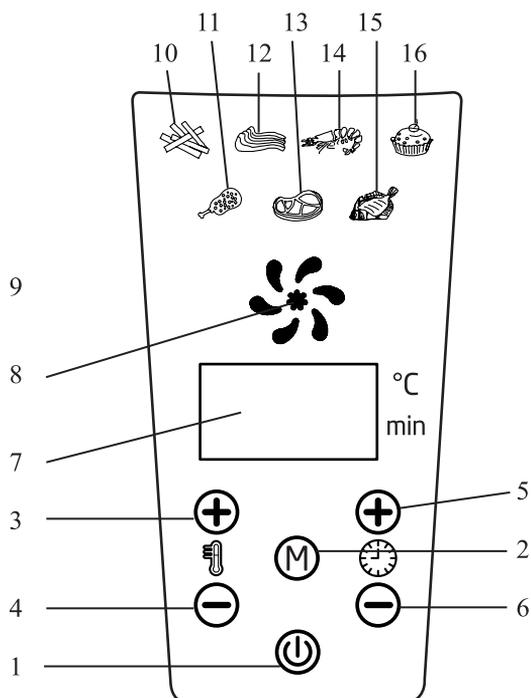
1. Кнопка «Вкл/Выкл». Переводит аэрогриль в режим ожидания, запускает приготовление, или завершает процесс приготовления. Загорается, когда аэрогриль подключен к сети. Параметры приготовления по умолчанию: температура 180 °С и время 15 минут.
