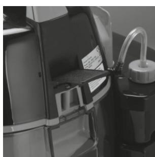
Налейте примерно 2.5л чистой воды в прозрачный бачок (1) так, чтобы параллельный основанию патрубок L- образной трубки (40) был покрыт водой
