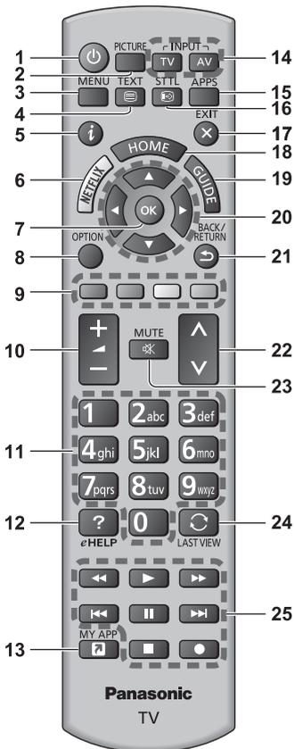
1 [POWER]: Вмикає / вимикає (режим очікування) телевізор
