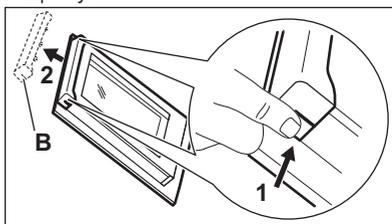
3. Чтобы снять дверную планку, потяните ее вперед.
