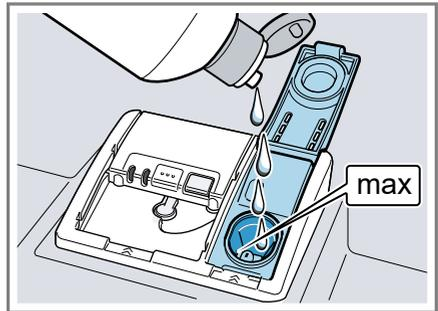
3. Если ополаскиватель перелился за край, удалите его из посудомоечной машины. Вытекший ополаскиватель может вызвать избыточное образование пены в процессе мытья.
