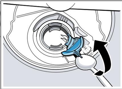
6. Приподнимите крышку насоса, направив ее наискось вовнутрь, и снимите.
