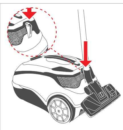
Для крепления всасывающей трубы на приборе использовать парковочное устройство, расположенное на телескопической трубе. Для этого вставить пластмассовое ребро парковочного фиксатора в паз, расположенный на задней стороне прибора.
