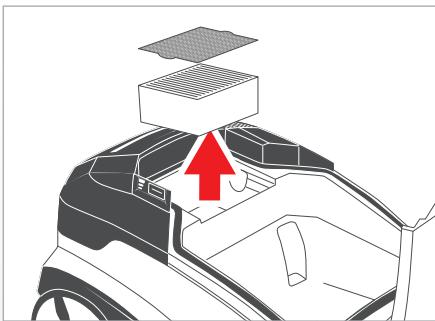
**Очистка специального гигиенического фильтра HEPA13 и фильтра предварительной очистки**
