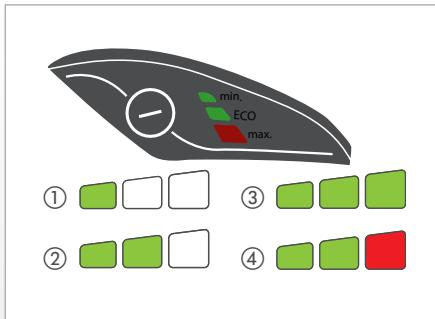
Включить прибор коротким нажатием на кнопку пуска на приборе или на пульте дистанционного управления\*. Прибор включается в эко-режим (Eco), на что указывается загоранием двух зеленых светодиодов.
