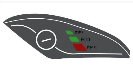
Прибор выключается более длительным нажатием кнопки пуска на приборе или - в зависимости от модели - кнопки Ⓛ на рукоятке\*. При повторном включении прибор включается сразу же на ранее выбранный уровень мощности всасывания, если он не был отсоединен от электрической сети.
