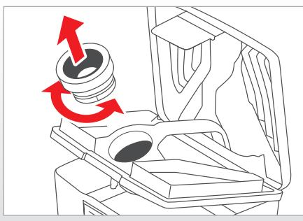
При сильном загрязнении так называемый инжектор можно снять в целях очистки, вращая уплотнение патрубка.
