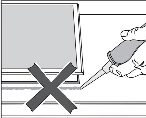
**!** Повреждения вследствие неправильного встраивания. При необходимости демонтажа панель конфорок и столешница могут быть повреждены, если панель была приклеена на герметик. Не используйте герметики между панелью конфорок и столешницей. Уплотнение под краем панели конфорок обеспечивает достаточную герметизацию столешницы.
