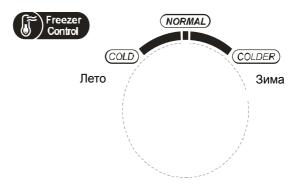
Температурный режим морозильной камеры может выбираться в зависимости от температуры окружающей среды. Обычно достаточно режима NORMAL. В летнее время года, или при повышенной температуре окружающей среды (выше +35 градусов Цельсия) рекомендуется устанавливать режим COLD. Если температура окружающей среды ниже +10 градусов Цельсия, то рекомендуется выбор режима COLDER.
