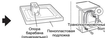
Снимите транспортировочные болты и опоры.
