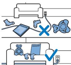
Перед включением робота-пылесоса уберите с пола все незакрепленные и хрупкие предметы, а также кабели, провода и шнуры.
