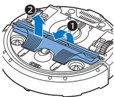
**7** Откройте фиксаторы сопла TriActive XL. Для этого вставьте пальцы в места, указанные стрелками, и снимите сопло TriActive с робота-пылесоса.
