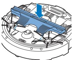
**10** Вставьте фиксаторы сопла TriActive в отверстия на нижней части робота-пылесоса. Задвиньте сопло TriActive в корпус. Убедитесь в том, что сопло свободно движется на несколько миллиметров вверх и вниз.
