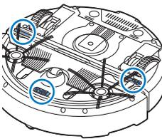
Робот-пылесос оснащен тремя датчиками перепада высот, расположенными на его нижней стороне. С помощью этих датчиков робот-пылесос распознает перепады высот (например, лестницы) и избегает их.
