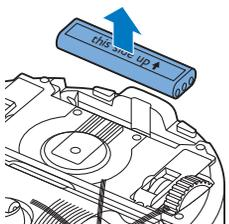
4 Поднимите аккумулятор и отсоедините его.
