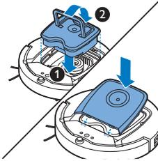
**7** Установите пылесборник в отделение для пылесборника, закройте робот-пылесос верхней крышкой.
