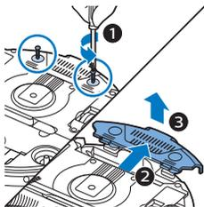
3 Отвинтите винты на крышке отсека для батарей и снимите крышку.
