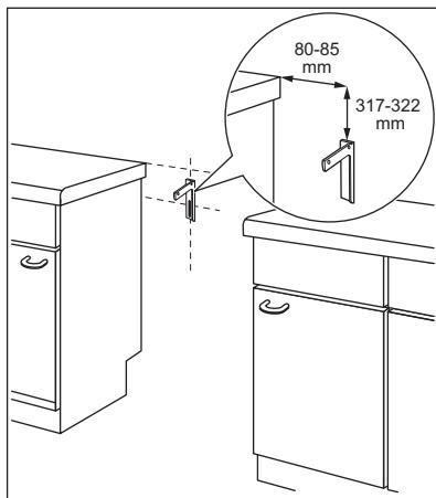
2. Отверстие для крепления находится слева на задней стороне прибора. Поднимите переднюю часть прибора и поместите его между кухонными шкафами. Если расстояние между кухонными шкафами больше, чем ширина прибора, следует установить его так, чтобы зазоры с обеих сторон были одинаковыми.
