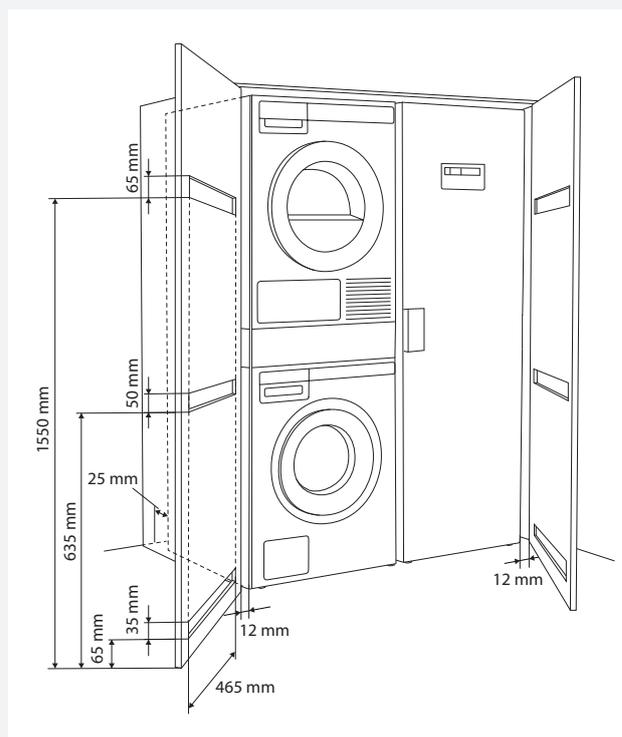
💡 После установки дверь сушильной машины должна беспрепятственно открываться.
