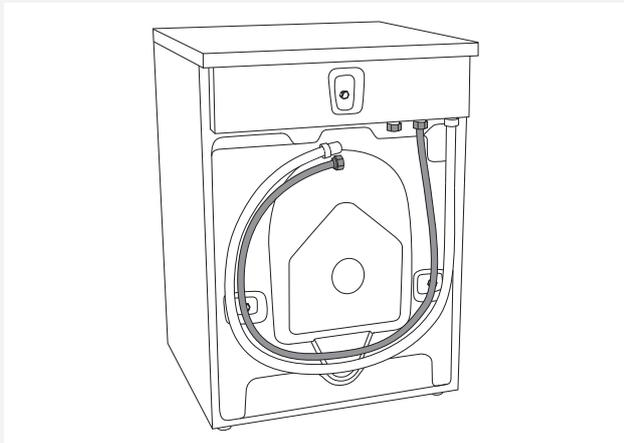
Заливной шланг крепко прикрутите руками, чтобы избежать протечек воды. После прикручивания проверьте герметичность соединения.
