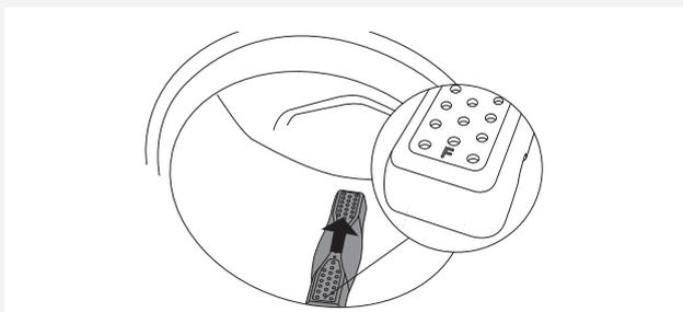
**5** Вставьте ребро в монтажное отверстие так, чтобы отметка F была обращена к вам. Убедитесь, что все зажимы ребра располагаются в соответствующих отверстиях в барабане. Нажмите до фиксации, как показано на рисунке.
