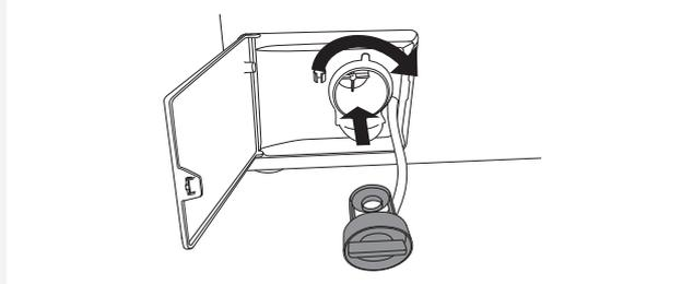
**1** Перед очисткой слейте воду из машины с помощью программы Слив и отключите машину от электросети.
