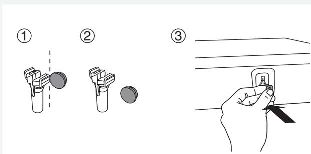
**3** Снимите с втулок заглушки и закройте заглушками три образовавшихся отверстия. Сохраните винты и втулки для возможной транспортировки машины в будущем.
