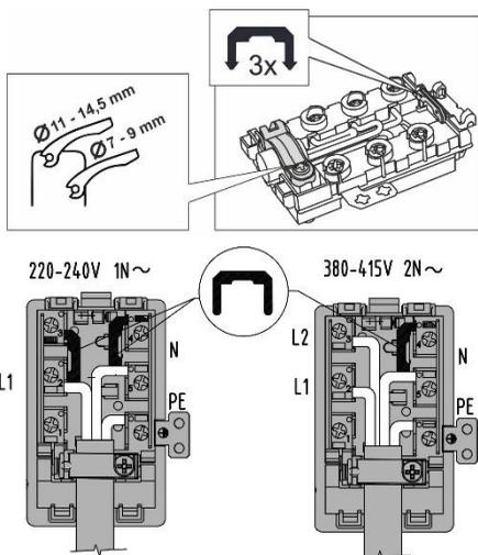
В случае неразъемного подключения к электросети установите до прибора размыкающее устройство с расстоянием между разомкнутыми контактами не менее 3 миллиметров.
