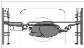
Подготовленное мясо насадите на вертел и с двух сторон закрепите его вилками. Закрутите винты на вилках. Прикрутите ручку к вертелу. Острый конец вертела вставьте в муфту мотора (отверстие на задней стенке духовки справа), которая закрыта крышкой. Переднюю часть вертела установите в выемку в передней части рамки. Перед тем как закрыть дверцу духовки, открутите ручку вертела.
