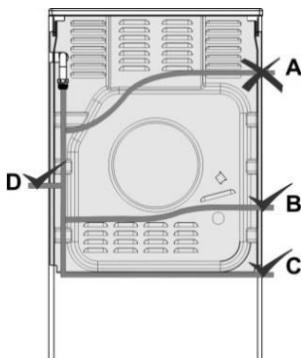
Если прибор подключается с помощью гибкого шланга, не допускается прокладка шланга, обозначенная на рисунке буквой "А".
