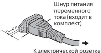
Между штекером и основным блоком остается зазор, даже если шнур питания переменного тока подсоединен плотно. Кабель должен быть подсоединен именно таким образом. Это не является признаком неисправности.
