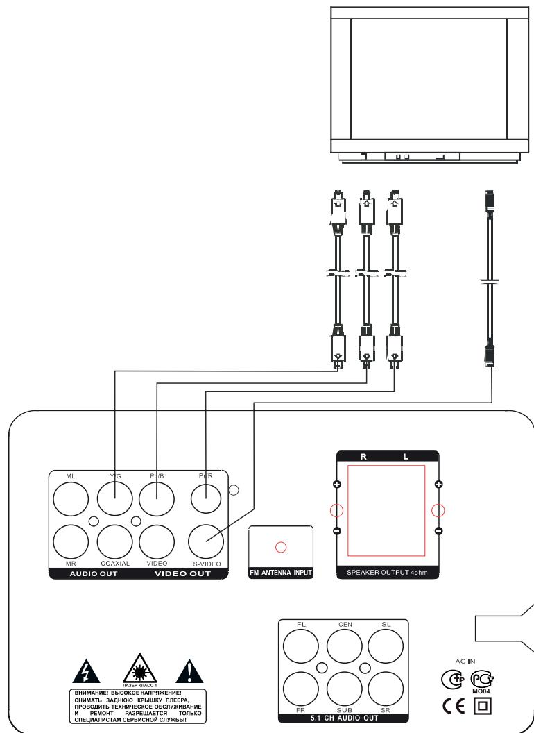
**Внимание:** На рисунке представлена схема подключения микросистемы H-MS160, подключение микросистемы H-MS160 производится аналогичным образом.
