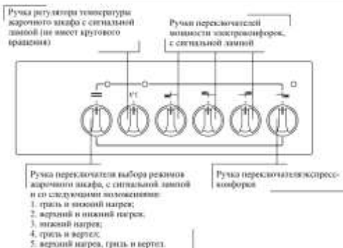
Рис. 11. Передняя панель плиты ЭП41/03
