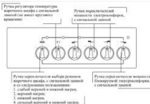
Рис. 10. Передняя панель плиты ЭП411
