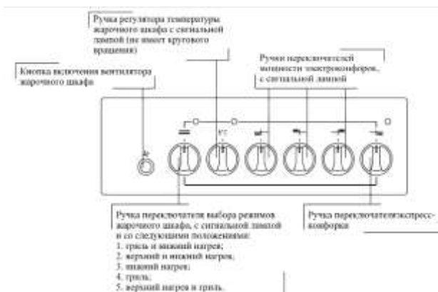
Рис. 12. Передняя панель плиты ЭП4/1з04
