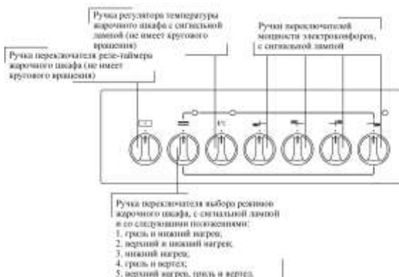
Рис. 13. Передняя панель плиты ЭП43р3
