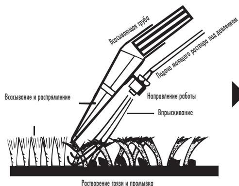
Нажать рычаг запорного клапана (24) до выхода моющей жидкости, а приложенную к коврам насадку провести прямой полосой по коврам. В конце полосы или при перерыве отпустить рычаг клапана, чтобы остановить струйное распыление. После того как распыленная жидкость собрана, приподнять насадку и начать новую полосу с небольшим наложением на предыдущую. Так полосу за полосой можно обработать всю поверхность.
