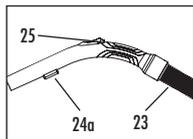
Всасывающий шланг (23) с креплением запорного вентиля (24a) и мех. регулированием силы всасывания (25)
