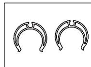
затискача для кріплення розпилювального шланга на всмоктувальній трубі
