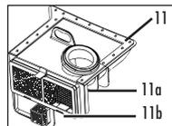
Комплект АКВА-фильтра (11) с губчатым фильтром (11a) и всасывающим фильтром (11b)<sup>2</sup>
