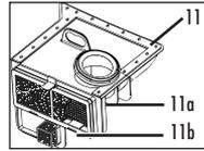
Аквафільтр у зборі (11) із губчастим фільтром (11а) та всмоктувальним фільтром (11b)<sup>2</sup>
