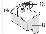
Контейнер для брудної води (12) з вологим фільтром (12а) та поплавцевим вимикачем (12b)<sup>2</sup>
