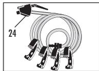
Экстракционная трубка с запорным вентилем (24) и кольцами для монтажа на шланг
