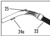
Всмоктувальний шланг (23) та коліно із вбудованим кріпленням для запірної клапана (24а) та механічним регулятором потужності всмоктування (25)
