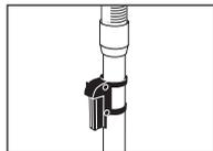
Изменяемая по высоте телескопическая всасывающая труба с фиксатором для стоячного положения
