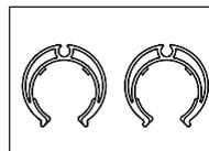
крепёжных клипсы для крепления экстракционного шланга на всасывающем шланге
