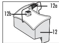
Резервуар для грязной воды (12), включая «мокрый» фильтр (12a) и поплавок (12b)<sup>2</sup>
