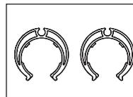
затискача для кріплення розпилювального шланга на всмоктувальному шлангу (встановлені на розпилювальну трубку запірної клапана)
