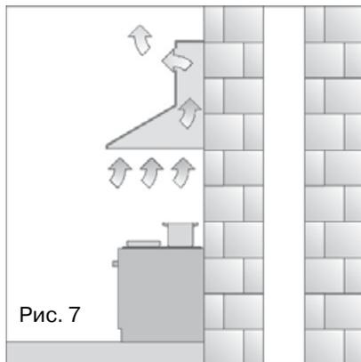
В этом режиме на вытяжку должны быть установлены угольные акриловые одноразовые запахоулавливающие фильтры. Эти фильтры не входят в комплект вытяжки и приобретаются отдельно. Использование вытяжки в режиме рециркуляции снижает ее производительность.
