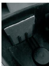
Снимите контейнер для сбора пыли и затем извлеките фильтр двигателя.
