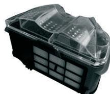
Извлеките HEPA-фильтр со стенки контейнера для сбора пыли и почистите его щеткой. При сильном загрязнении промойте HEPA-фильтр прохладной водой, а затем дайте ему высокнуть в течение суток естественным способом. Запрещается мыть фильтр горячей водой или использовать для его мытья моющие средства. Запрещается сушить HEPA-фильтра с помощью фена или обогревательных приборов. Установите HEPA-фильтр обратно в контейнер, а контейнер установите на пылесос. Закройте верхнюю крышку.
