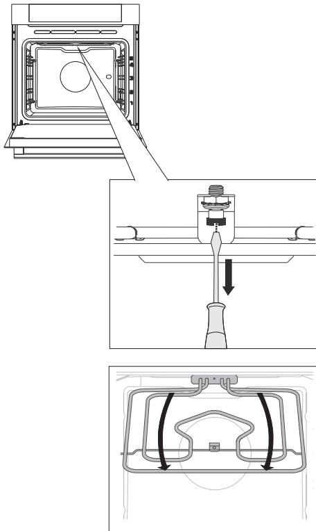
**1** Чтобы освободить верхние нагреватели, открутите винт в передней части потолка духовки.
