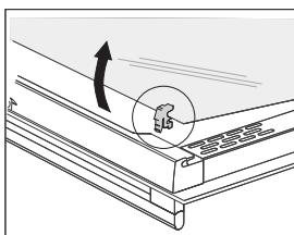
**3** Чтобы снять внутреннее третье стекло (в некоторых моделях), приподнимите его и снимите. Снимите также прокладки со стекла.
