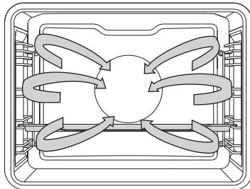
Одновременно работают нагревательный элемент вокруг вентилятора и вентилятор. Вентилятор создает постоянную циркуляцию горячего воздуха вокруг мяса или выпечки.
