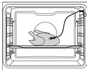
**2** Штекер зонда вставьте в гнездо и воткните зонд в кусок мяса. Если были установлены функции, программирующие время работы прибора, они обнулятся.
