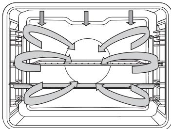
Одновременно работают верхний нагревательный элемент, инфранагреватель и нагревательный элемент вокруг вентилятора. Используется для приготовления всех видов мяса.
