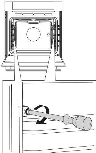
**1** Открутите винт с помощью отвертки.
