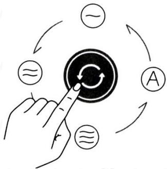
При последовательном одинарном нажатии на кнопку включения и выбора режимов сначала включается 1 режим, затем 2 режим, затем 3 режим, затем автоматический режим.
