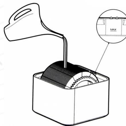
Перед установкой верхнего кожуха воду можно залить непосредственно в резервуар до максимальной отметки (Выступ с отметкой "MAX").
