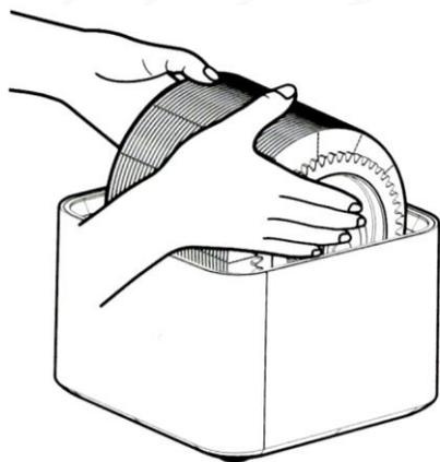
Как показано на рисунке, для снятия испарительных пластин следует повернуть ручку по часовой стрелке.
