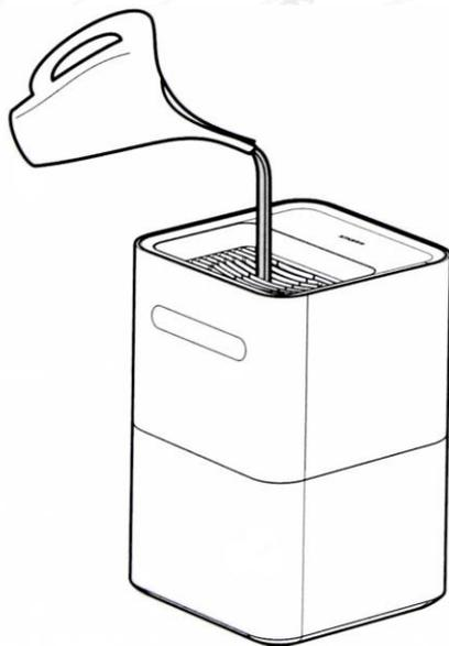
Когда устройство включено, залить воду можно непосредственно через решетку. При этом индикатор уровня воды в резервуаре изменяется в соответствии с добавленным объемом воды, когда индикатор горит в полную яркость, следует прекратить добавление воды
