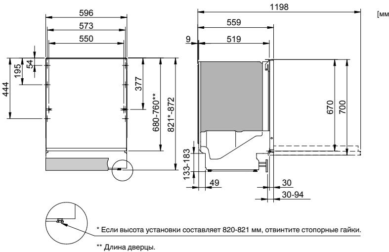
\* Если высота установки составляет 820-821 мм, отвинтите стопорные гайки.
