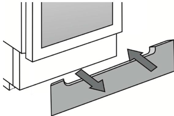
**У встраиваемых в мебельную нишу** винных шкафов нет вентиляционной решетки, и для обеспечения отвода горячего воздуха необходимо предусмотреть сквозную вентиляционную нишу от цоколя до верхней части мебельного модуля (см. рисунок). Площадь вентиляционной ниши должна быть не менее  $200\text{ cm}^2$ .
