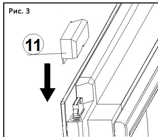
3. Аккуратно удалите плоской отверткой прокладку в верхней части, чтобы получить доступ к задней крышке дисплея (см. рис. 4).
