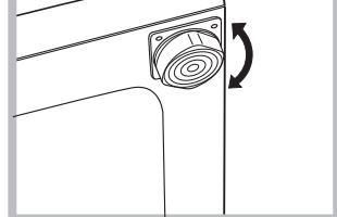
Належне вирівнювання надає стабільність машині та запобігає вібрації, шуму та пересуванню під час роботи. При встановленні машини на килимовому покрівлі або килимі відрегулюйте ніжки таким чином, щоб залишити під пральною машину достатній простір для вентиляції.
