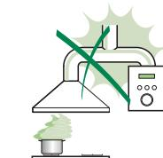
Sluit de afzuiginrichting op het rookkanaal aan met een pijp met een minimale diameter van 120 mm. De rook moet een zo kort mogelijk traject afleggen.
