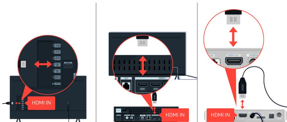
Отсоедините и снова подключите кабели питания и кабели HDMI с обратной стороны телевизора или приставки One Connect, затем извлеките кабель питания из розетки и снова подключите его.
