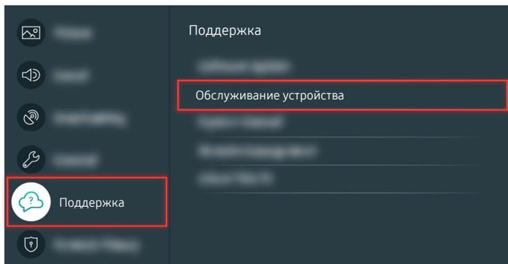
Чтобы проверить звуковой вывод, выберите
