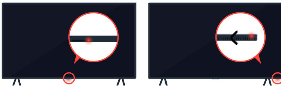
Если телевизор не включается, проверьте, включен ли датчик пульта ДУ.
