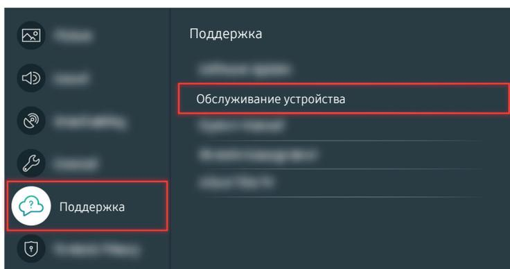
Чтобы проверить звук, выберите [🏠](#) > [⚙️ Настройки](#) > [Поддержка](#) > [Обслуживание устройства](#) > [Самодиагностика](#) > [Звуковой тест](#).
