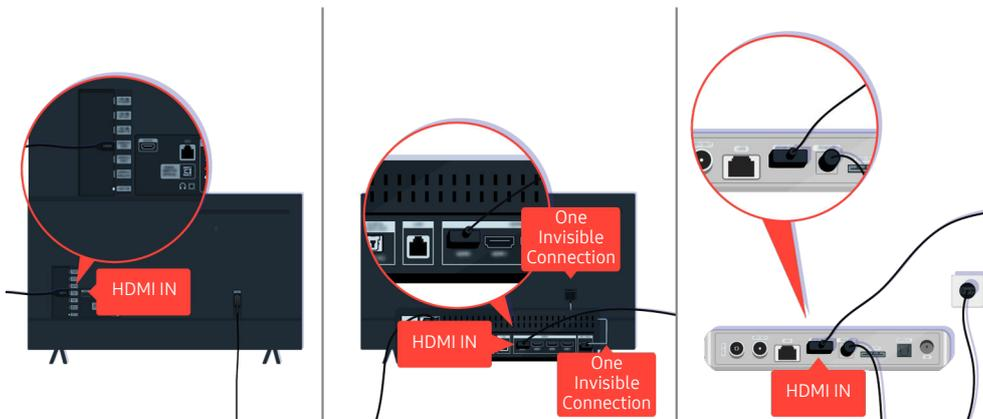
Проверьте подключение кабеля HDMI к телевизору или приставке One Connect.
