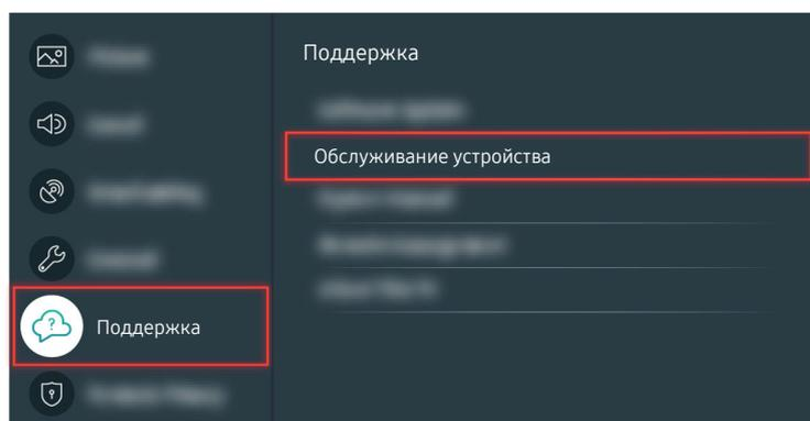
Чтобы проверить силу сигнала, выберите
