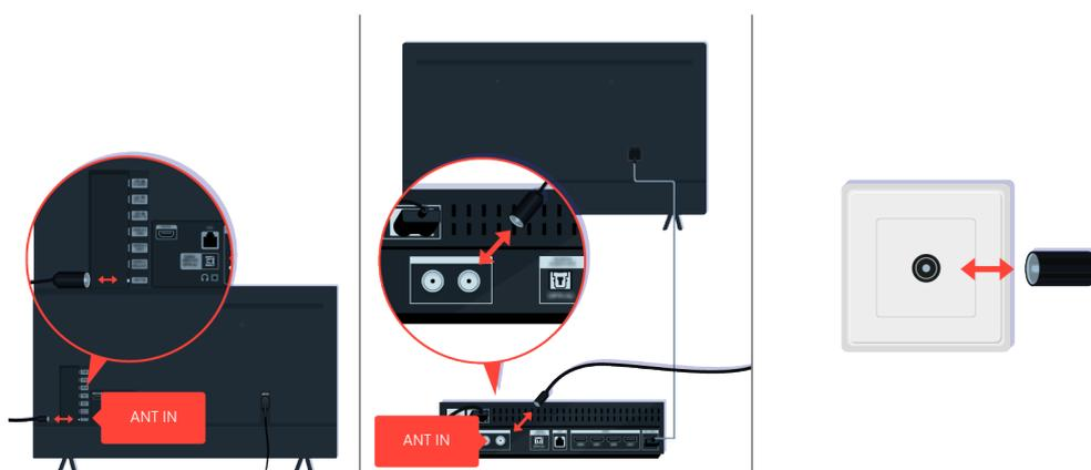
Проверьте подключение антенны и кабеля входного сигнала.
