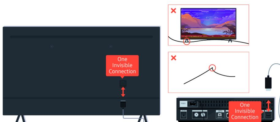
Если устранить проблему не удастся и ваш телевизор использует One Invisible Connection, отсоедините и снова подключите кабель One Invisible Connection к телевизору и приставке One Connect. Убедитесь, что кабель One Invisible Connection не зажат и не перегнут.
