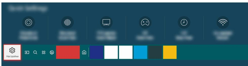
Чтобы проверить звук, выберите [🏠](#) > [⚙️ Настройки](#) > [Поддержка](#) > [Обслуживание устройства](#) > [Самодиагностика](#) > [Звуковой тест](#).
