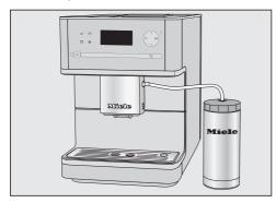
■ Поставьте емкость для молока рядом с кофемашиной. Вставьте молочную трубку в разъем на центральной насадке.
